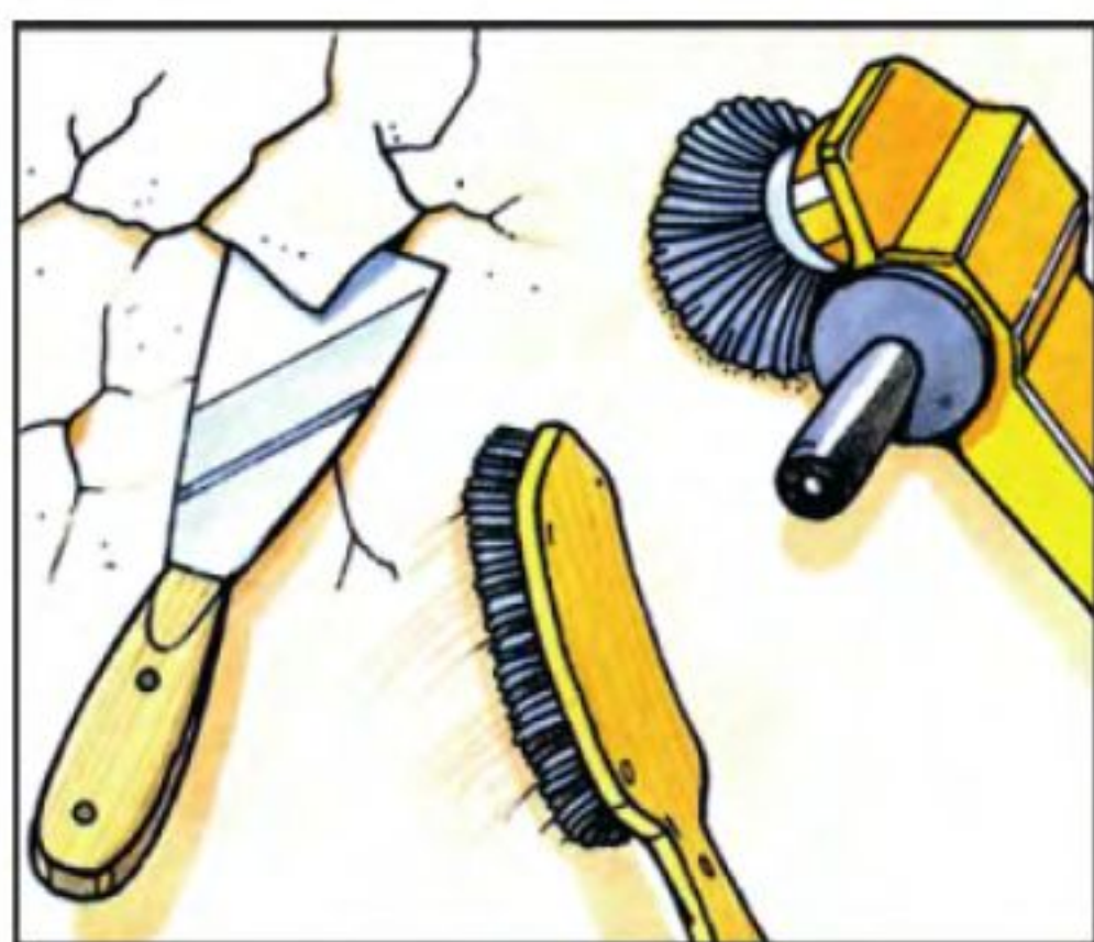
Рис. 7. облупившуюся краску, как и непрочное или нанесённое толстым слоем известковое покрытие, нужно удалить механическим способом. В некоторых ситуациях для этого можно использовать паяльную лампу или химическое средство для смывки.
